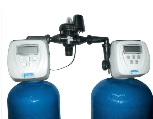
Gli Addolcitori RAEMA della serie ECONOMY mod. HF WLEV DUPLEX con timer elettronico, sono costituiti da 2 Colonne, con 2 Valvole, da una valvola motorizzata a 3 vie e da 2 Tini salamoia per dare maggiore autonomia tra una rigenerazione e l'altra, in quanto funzionano in alternanza erogando sempre acqua addolcita 24 ore su 24.
