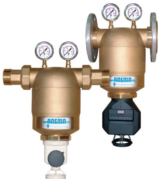
Il filtro è costituito da un corpo in ottone, una cartuccia in acciaio inox, una girante per la pulizia della cartuccia - costruito a regola d'arte e secondo Normative Europee. Attacchi flangiati.
