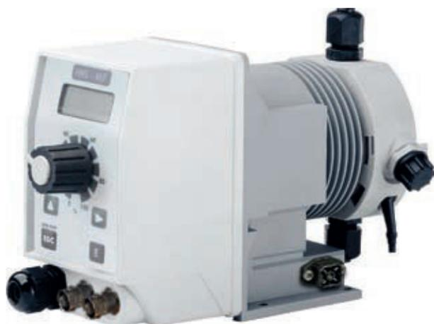
Pompa dosatrice ad uso ANTILEGIONELLA a montaggio orizzontale con microprocessore, display LCD, multifunzioni - proporzionale a segnali analogici / digitali con controllo di livello, doppia regolazione della portata, frequenza e singola iniezione programmabile in 7 differenti modalità:
